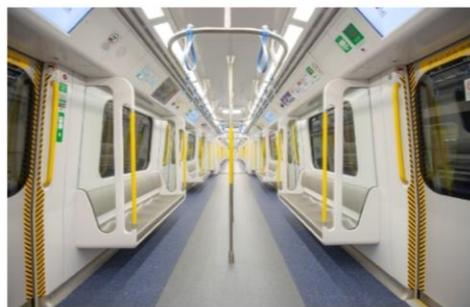
車廂比現有列車的車廂闊約 12 厘米，提供更寬敞的乘車空間之餘，亦可收窄月台與車廂之間的空隙
