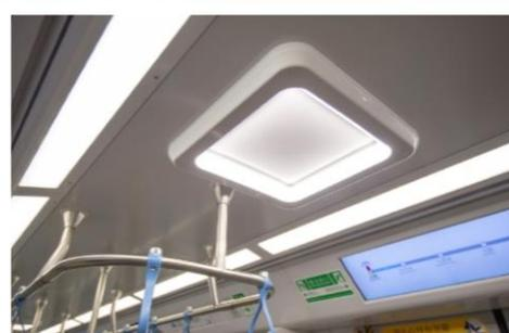
採用環保的二極管(LED)車廂照明系統，營造更明亮的乘車環境
