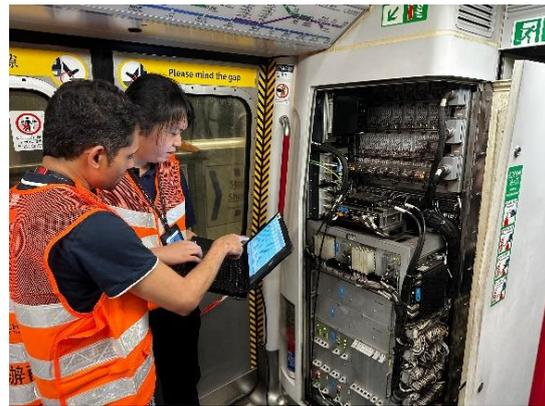
2. 荃灣綫新信號系統列車測試的項目包括行車暢順度、停車準確度、車門與月台幕門的操作、乘客資訊顯示的運作，以及車務控制中心、車隊和車站的溝通協調等，並在過程中進行調整。圖為今年八月初在葵興站測試列車的停車準確度，及在葵芳站測試車門與自動月台閘門的操作。
