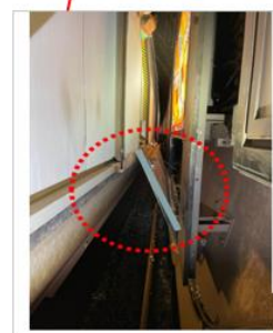
現場圖片顯示肇事活門面板在事發後向車身方向傾斜
